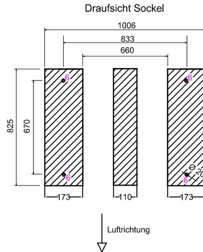
Kein Gewähr auf Richtigkeit. Diese Zeichnung stellt ein Prinzipschema dar und kann je nach Gegebenheit von der Praxis abweichen. Eine Vervielfältigung darf nur mit schriftlicher Zustimmung der LAMBDA Wärmepumpen GmbH erfolgen.
