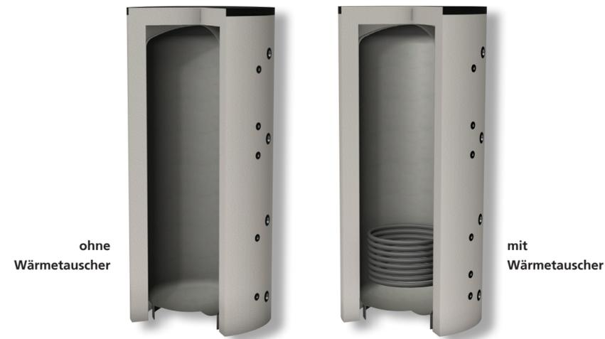
Pufferspeicher sind zentrale Komponenten moderner Heizungsanlagen. Sie verbinden Wärmelieferanten wie wasserführende Kamine oder Gasbrennwertthermen und Wärmeverbraucher, z. B. Frischwasserstationen und Heizkreise. Dank des Speichervolumens kann besonders bei Festbrennstoffkesseln und Solarthermieanlagen die Zeitspanne zwischen Wärmezeugung und Wärmebedarf überbrückt werden.
